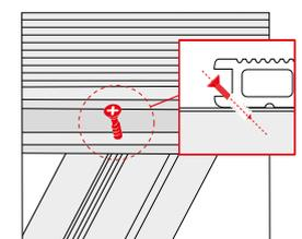
**5.3** Schieben Sie die untere Feder der zweiten Terrassendiele unter die Clips/Schiene. Stellen Sie sicher, dass die Dielenenden ausgerichtet sind, und verwenden Sie bei Bedarf einen Gummihammer oder Klemmen, um den richtigen Abstand zur benachbarten Diele zu gewährleisten. Setzen Sie die Fixierschraube auf der anderen Seite der Terrassendiele ein, und befestigen Sie die Clips/Schiene auch auf dieser Seite. Wiederholen Sie den Vorgang mit den übrigen Terrassendielen.
